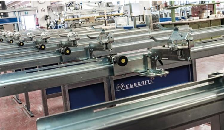
Der „Messerfix“ ist eine Universal-Schleifvorrichtung für alle gängigen Mähmesser und Heckenscheren. Mit dieser Schleifvorrichtung wird das Schärfen der Mähmesser für jedermann leicht gemacht.
