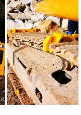
Auf schwierigem Terrain erhöhen die Steighilfen der Firma Esto die Bodenhaftung. Besonders bei Eis und Schnee können die Steighilfen gegen seitliches Abrutschen von Baggern und Raupenfahrzeugen in steiler Hanglage schützen. Überzeugen Sie sich von unserer Kompetenz!
